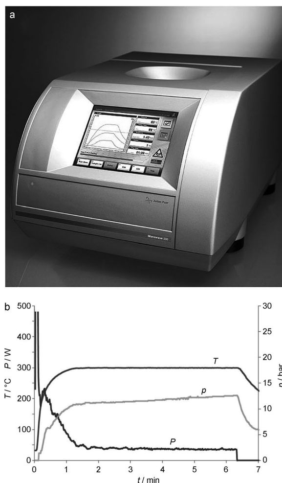
Abbildung 1. a) Photo eines Monomode-Mikrowellenreaktors (Monowave 300, Anton Paar GmbH), der mit bis zu 850 W Magnetronleistung betrieben werden kann und mit einem dualen internen/externen Temperaturüberwachungssystem ausgestattet ist. b) Temperatur- ( T ), Druck- ( p ) und Leistungsprofile ( P ) wurden für eine 3-mL-Ethylenglycolprobe aufgezeichnet, die im geschlossenen System im Monowave-300-Reaktor auf 300 °C mikrowellenerhitzt wurde. Aus Gründen der Übersichtlichkeit ist nur das Temperaturprofil der internen Faseroptiksonde gezeigt und die y-Achse bei 500 W abgeschnitten.
